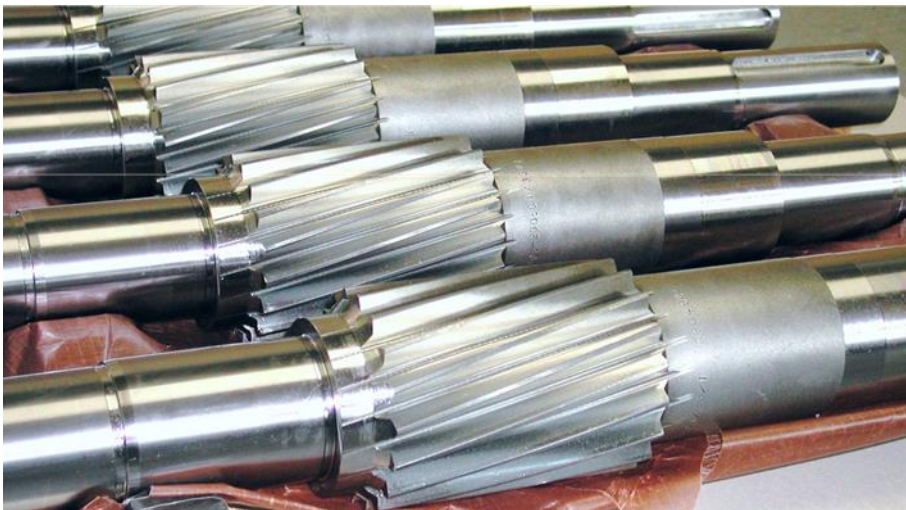
Ritzelwellen für Hafenkran, gehärtet und geschliffen
