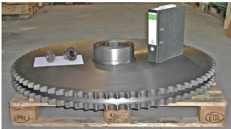
Doppelkettenrad 24B-2 , 76 Zähne, Kopfkreis-Ø 940mm
