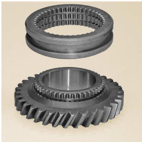
Kupplungselemente für Traktor-Schaltgetriebe, innen und außen, konisch gestoßen
