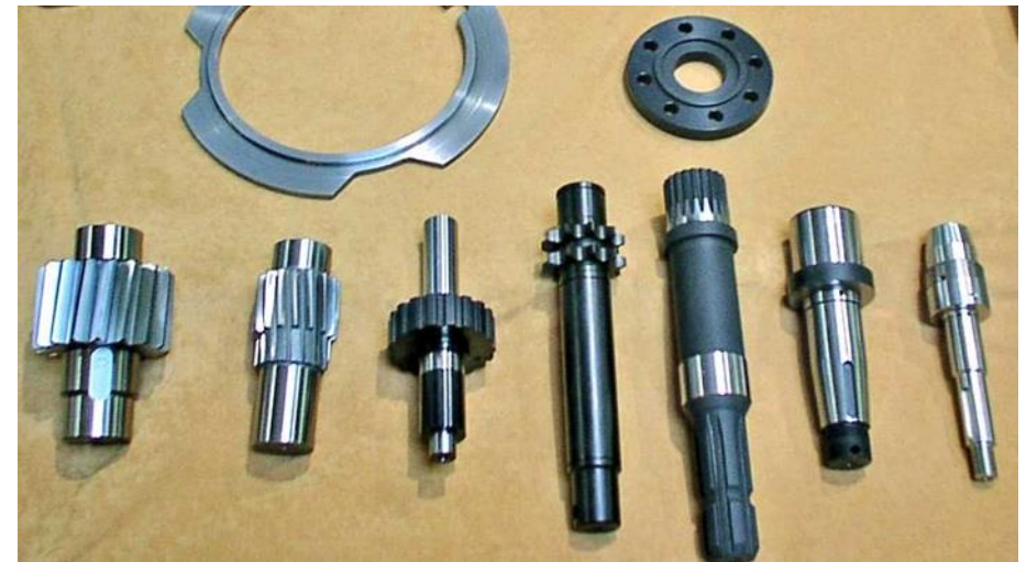
Drehteile, teilweise verzahnt, gehärtet und geschliffen
