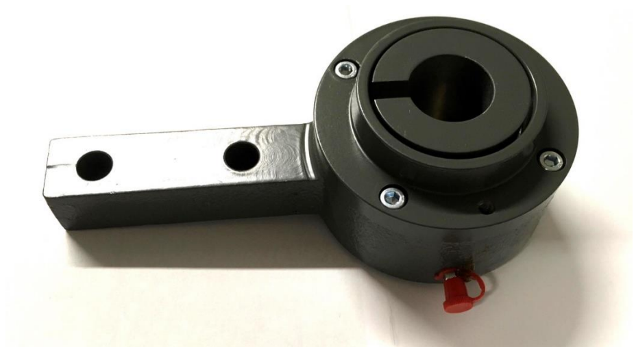
Schweißbaugruppe für Straßenkehrfahrzeug (Stahl / Stahlguß)
